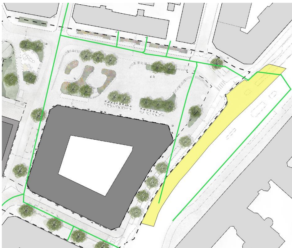
Figur 24. Del av Övre Husargatan/Skanstorget som föreslås avvattnas till föreslaget BGG-system markerat med gult. Befintliga dagvattenledningar markerade med grönt.
