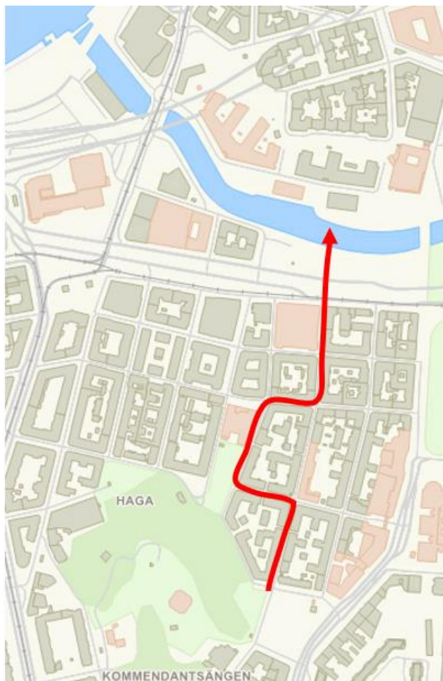
Figur 15. Den röda pilen visar hur avledningen sker från planområdet via dagvattenledningar. (Gokart 2023).
