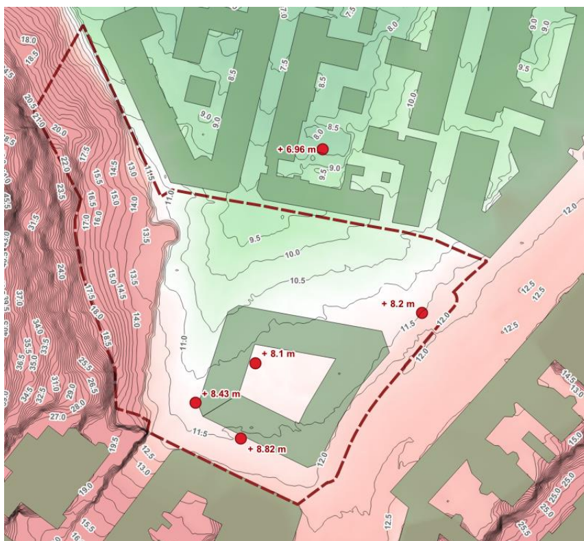
Figur 14: Grundvattennivåer vid Skanstorget. Röda punkter visar placeringen på mätpunkterna med deras medelvärde och svarta linjerna visar dagens marknivåer. Källa: Göteborg Stad.
