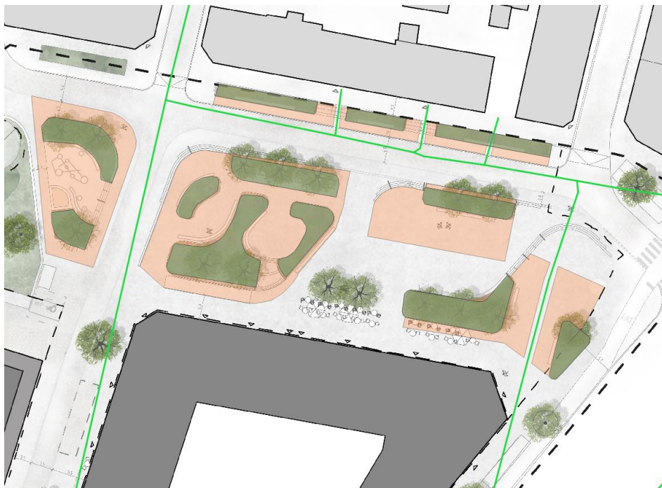
Figur 58. Röd polygon visar förslag på öppna förstärkningslager i ett BGG-system (totalt ca 1 600 m 2 ). Grön markering är befintligt kommunalt dagvattennät.
