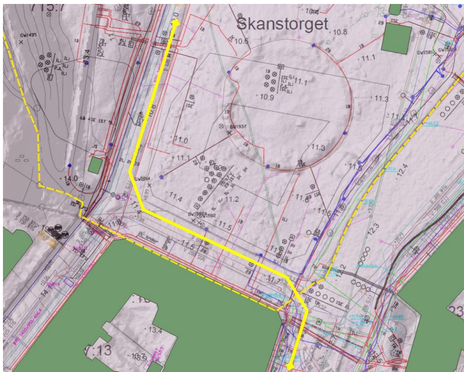
Figur 76: Illustration med möjlig placering av rännan med avseende mer befintliga underjordiska ledningar. Det observeras att medan mest av det utpekade stråket ligger där det inte finns så många andra ledningar. I den södra delen vid Övre Husargatan är det ont om plats.
