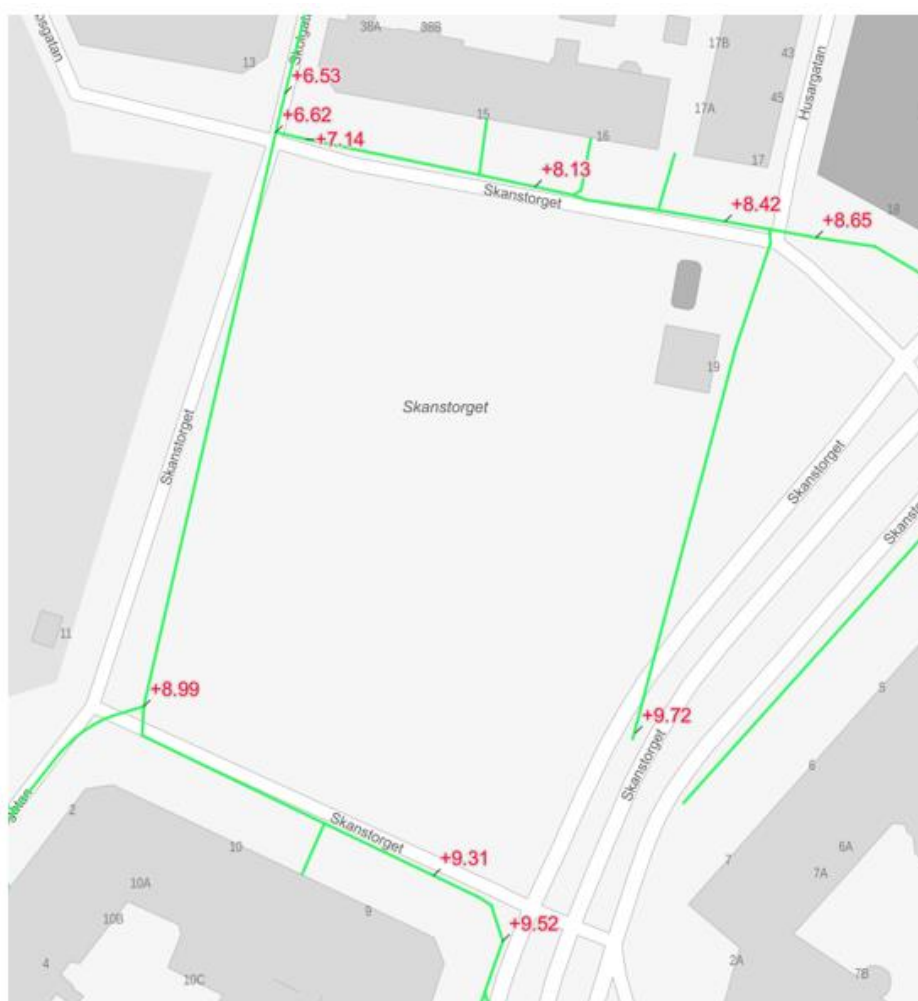
Figur 45. Bilder över befintligt dagvattennät markerat med grönt. Dagvattennätets + höjd över havet utskrivet med röda siffror i Rikets Höjdsystem 2000 (VA-banken, 2023).
