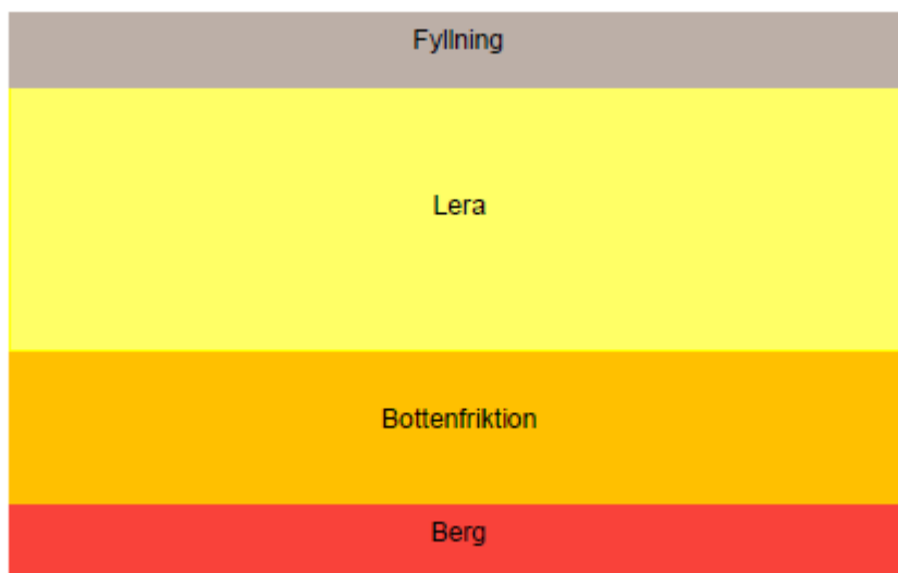
Figur 13. Schematisk skiss över jordlagerföljden inom området (WSP 2023).
